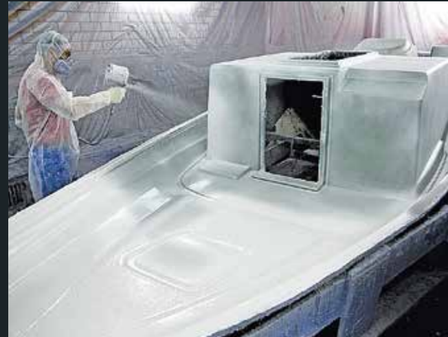
Gelcoat in mehrfach Schichten aufbringen
